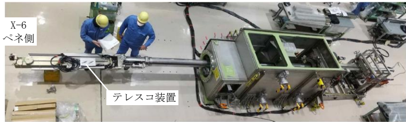
テレスコ式試験的取出し装置（装置を上方から撮影）工場での試験状況
