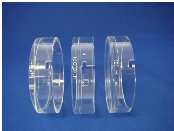
ビルドアップキャップカバー 3種類 左からH* (10) 用、H' (0.07) 用、H' (3) 用
